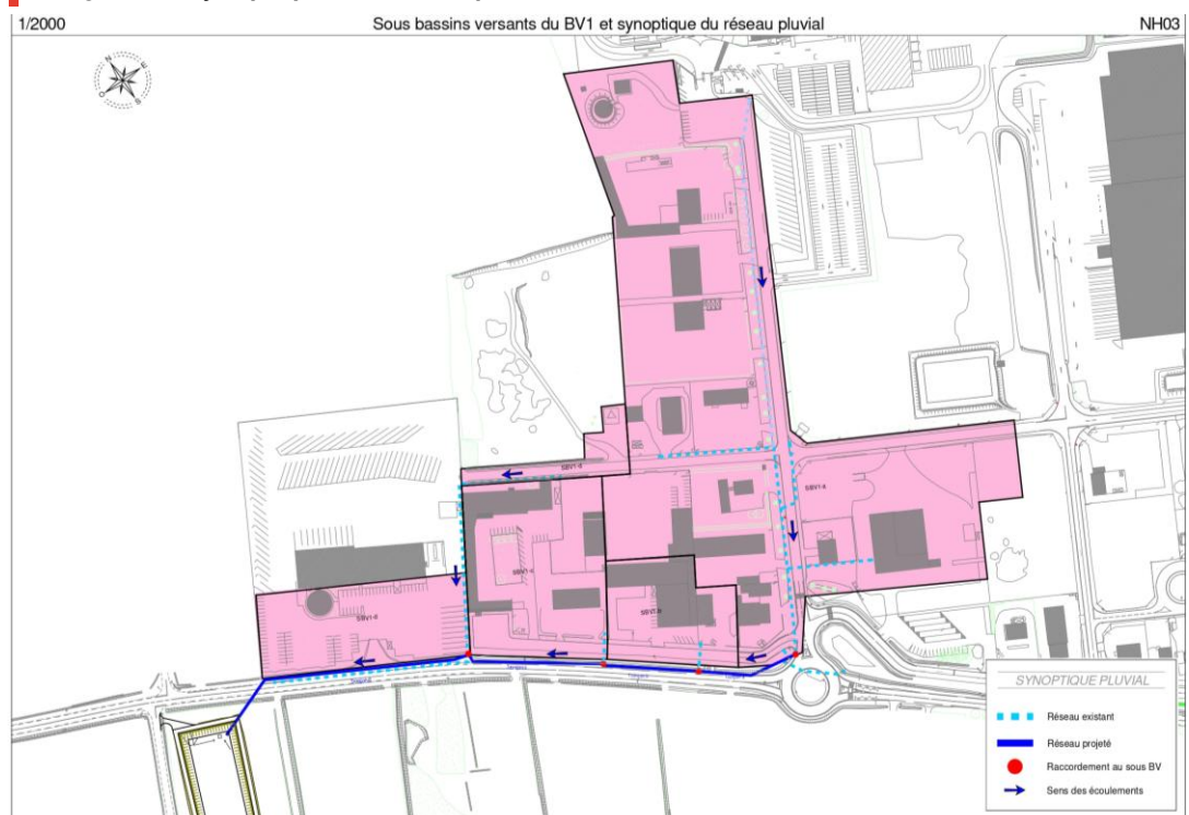
Figure 3 : Synoptique du réseau pluvial du bassin versant n°1
