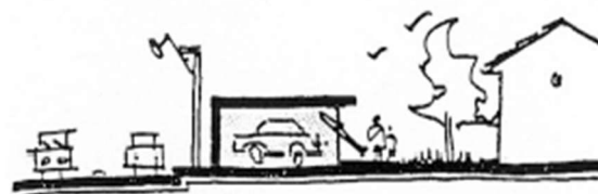
Garages situés à proximité d'une voie routière de manière à limiter la propagation des nuisances sonores.
