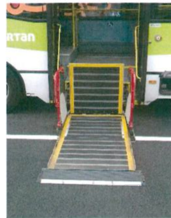
Figure 14 : Exemple de plate-forme d'accès sur un car
