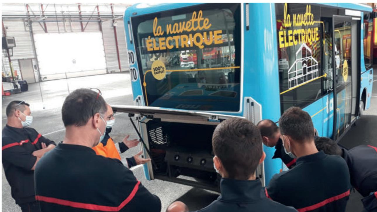
En 2020, 5 bus ont été équipés de système anti-incendie moteur de type FOGMAKER. Ce système détecte un début d'incendie moteur et émet un brouillard d'eau haute pression pour l'éteindre.
